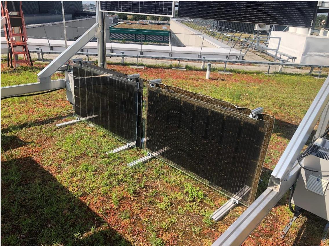
Abbildung 2: Referenz- und Mooskonstruktion auf dem Dach des ZPV Adlershof.
