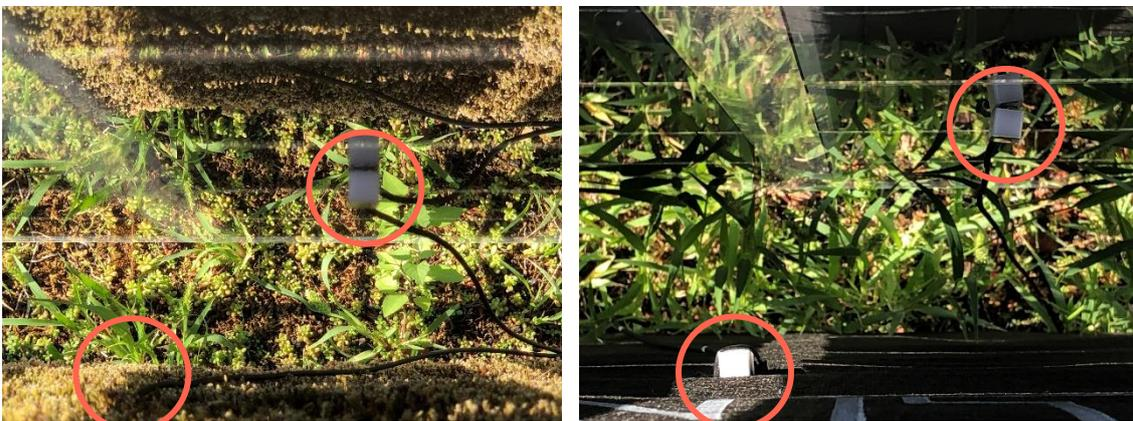
Abbildung 15: Temperatursensoren in der Mooskonstruktion (links); Temperatursensoren in der Referenzkonstruktion (rechts).
