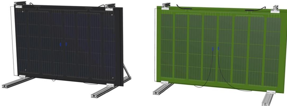
Abbildung 3: Baugleiche Konstruktionen mit verschiedenen Materialien hinter den PV-Modulen. Temperatursensoren (blau) befinden sich an der verschatteten Hinterseite der Module und auf den Materialoberflächen.
